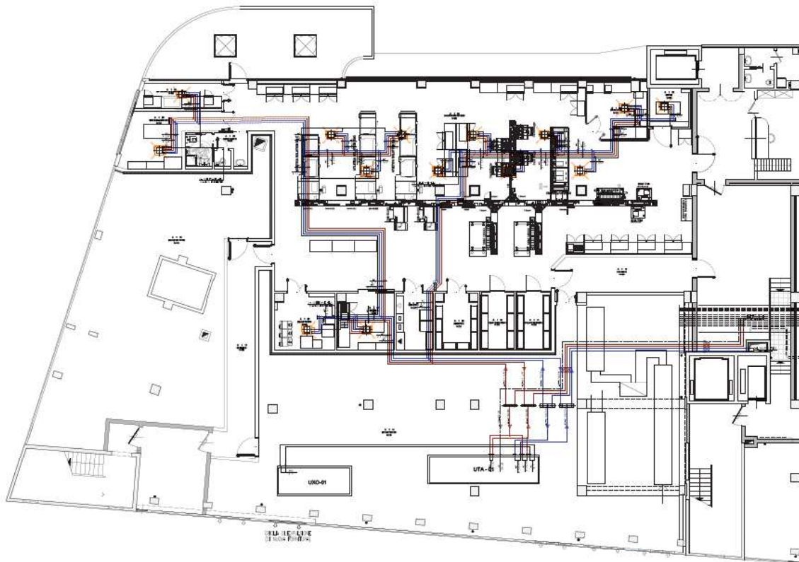
Pianta piano primo – progetto: distribuzione fluidi
